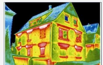
Mit einer Wärmebildkamera lassen sich Thermografieaufnahmen von Gebäuden machen. Die Kamera nimmt dabei die unterschiedliche Wärmestrahlung der abgebildeten Bauteile auf und gibt sie in Farbschattierungen wieder.
